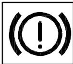
La luz indicadora se encenderá cuando el nivel de líquido de frenos sea bajo. Póngase en contacto con el centro de servicio postventa especializado inmediatamente. Si el interruptor de ignición está en la posición II, pero el freno de estacionamiento está accionado, la luz indicadora permanece encendida.
