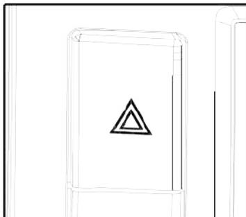
Presione el interruptor de la luz de advertencia de peligro, todas las luces direccionales parpadearán, presione el interruptor de nuevo para apagarlas. Cuando la llave de contacto está en posición "OFF", se pueden seguir utilizando las luces de advertencia de peligro.
