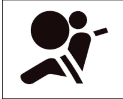
El testigo de fallo de la bolsa de aire en la pantalla del panel de instrumentos le avisará de cualquier fallo de la bolsa de aire y del pretensor del cinturón de seguridad. Cuando el interruptor de encendido está en la posición on, la luz de advertencia se encenderá y parpadeará durante 6-8 segundos antes de salir, lo que indica que el sistema funciona normalmente. Cuando el interruptor de encendido está en la posición "ACC" o "OFF", la bolsa de aire no funcionará.
