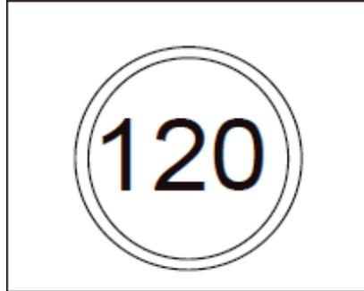
Los usuarios pueden establecerla velocidad de activación de esta alarma por sí mismos en el menú y la alarma se activa cuando la velocidad actual del vehículo supera la velocidad de alarma establecida.
