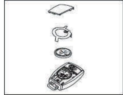
3.- Retire la batería evitando el contacto con las placas de circuitos y la batería.
