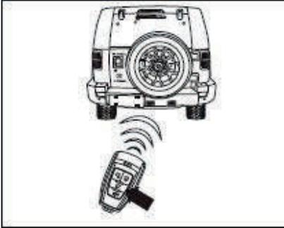
En el estado bloqueado, haga una pulsación larga y la puerta se desbloqueará. Después de abrir la puerta del maletero, la puerta del maletero se cerrará. Después de un período de tiempo, la puerta del maletero se bloqueará de nuevo automáticamente, y entra en el estado de alerta inmediatamente. Al abrir la puerta del maletero y cerrar la puerta del maletero, no ponga la llave en el vehículo, para prevenir que el vehículo se bloquee con las llaves adentro
