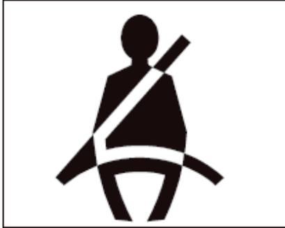
Si se ha activado el interruptor de encendido pero el conductor no abrocha el cinturón de seguridad, se encenderá el indicador luminoso del cinturón de seguridad en la pantalla del tablero de instrumentos. Si el conductor no abrocha el cinturón de seguridad y la velocidad del vehículo supera los 25 km/h, o cuando el vehículo avanza a una distancia de 500 m o durante más de 60 s a una velocidad inferior a 25 km/h, se encenderá inmediatamente el testigo, acompañado de una alarma sonora.
