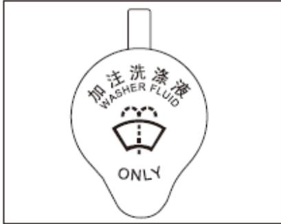
El líquido de lavado del parabrisas delantero y trasero se suministra desde el tanque de almacenamiento de líquido de lavado dentro del compartimiento del motor. Si se encuentra que el nivel del líquido de lavado es demasiado bajo, asegúrese de agregar rápidamente líquido de lavado en el tanque de almacenamiento.
