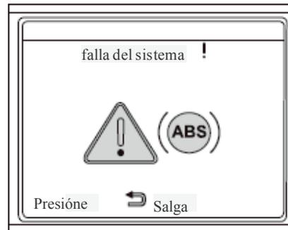
La figura muestra un ejemplo de interfaz de alarma de falla del sistema ABS. Además de la interfaz, se advertirá de los siguientes fallos:
