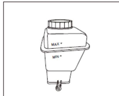
Cuando el motor está en el estado frío es el mejor momento para verificar si el nivel del líquido de frenos está dentro del rango marcado en el costado del tanque de almacenamiento.
