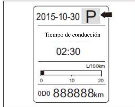
Para el modelo equipado con transmisión automática, la pantalla de indicación de marcha en el tablero de instrumentos mostrará la posición actual en la que la palanca de cambios está colocada.
