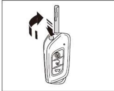
Si se presiona el botón en la llave remota, la llave mecánica saltará automáticamente. Para retirar la llave mecánica primero presione el botón, y luego doble la llave mecánica.
