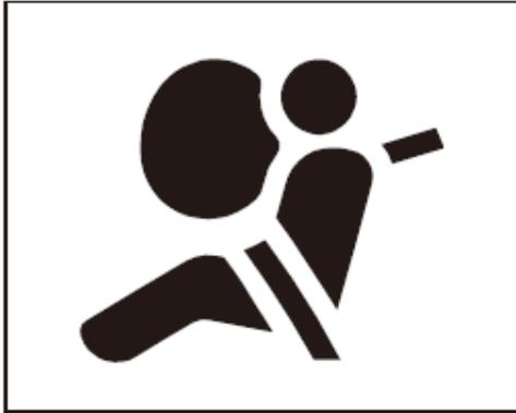
La luz de advertencia de falla en el sistema de airbag en el tablero de instrumentos le avisará si hay fallas en el sistema de airbag.
