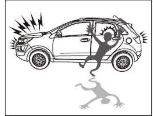
Cuando el vehículo está bloqueado por la llave remota, el vehículo completo se encuentra en estado fortificado, y todas las puertas, capó del motor y la tapa del maletero están en estado de ser monitoreado. Si las puertas, la tapa del maletero o el capó del motor están bloqueados y, por ejemplo, alguien fuerza la puerta, se activará la alarma.
