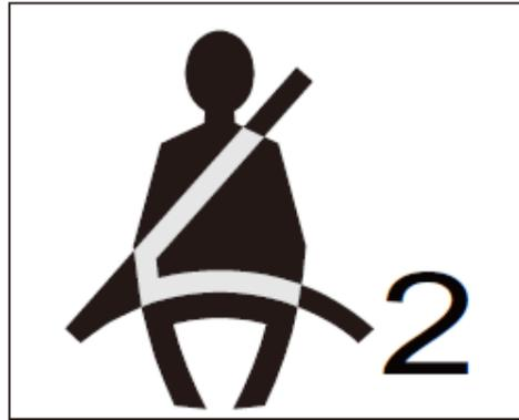
Cuando el vehículo está en marcha, si el acompañante no tiene ajustado el cinturón de seguridad la luz de advertencia del cinturón del acompañante permanecerá encendida. Cuando el cinturón de seguridad no está ajustado, si cualquiera de las siguientes circunstancias es detectada se oír un pitido durante 120 segundos, y la luz de advertencia parpadeará a la frecuencia de 1Hz:
