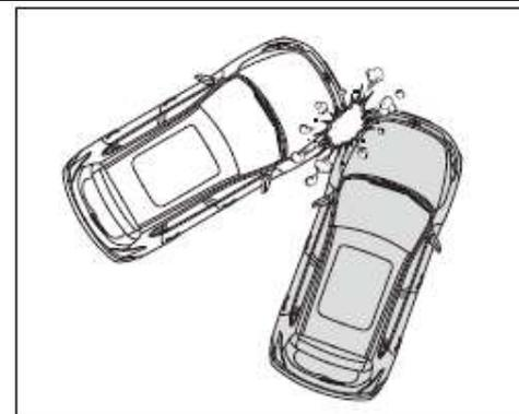
En caso de colisión fuera de ángulo, la energía de impacto recibida por el sistema de bolsas de aire puede no ser lo suficientemente alta como para activar la bolsa de aire frontal. En tal caso, la bolsa de aire delantera no debe activarse y la bolsa de aire lateral de cortina\* puede no funcionar.
