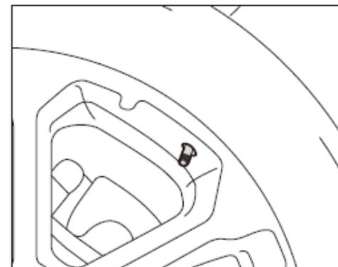
1. Desmonte la válvula de la llanta, y utilice el método de jabón para inspeccionar si la válvula tiene fugas.
