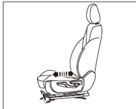
Ajuste del asiento hacia delante/hacia atrás: Tire hacia arriba de la varilla de ajuste situada debajo de la parte delantera del asiento y mueva el asiento hacia arriba o hacia atrás a la posición adecuada, suelte la varilla de ajuste y mueva ligeramente el asiento hacia arriba o hacia atrás, hasta que quede bloqueado de forma segura.
