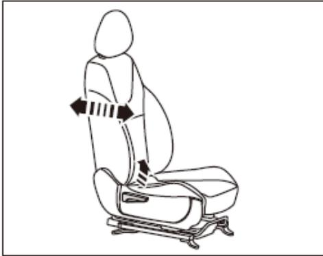
Tire de la empuñadura de ajuste y agite el respaldo del asiento hacia delante o hacia atrás con el ángulo de inclinación adecuado; suelte la empuñadura de ajuste y agite ligeramente el respaldo del asiento hacia delante o hacia atrás hasta que quede bloqueado de forma segura.
