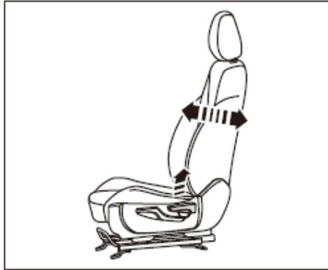
Tire de la empuñadura de ajuste y agite el respaldo del asiento hacia delante o hacia atrás buscando el ángulo de inclinación deseado, suelte la empuñadura de ajuste y mueva ligeramente el respaldo del asiento hacia delante o hacia atrás hasta que quede bloqueado de forma segura.
