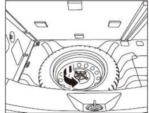
4. Desenrosque con la mano la el seguro en el centro del volante de repuesto en sentido antihorario y extraiga el volante de repuesto.
