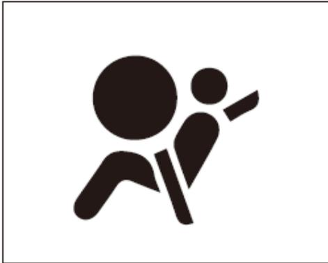
La luz de advertencia de fallo del sistema de bolsas de aire del panel de instrumentos le avisara al conductor de un fallo en el sistema de bolsas de aire.
