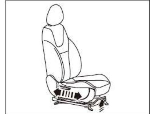
Tire hacia arriba de la varilla de ajuste situada debajo de la parte delantera del asiento y mueva el asiento hacia arriba o hacia atrás a la posición adecuada, suelte la varilla de ajuste y mueva ligeramente el asiento hacia arriba o hacia atrás, hasta que quede bloqueado de forma segura.
