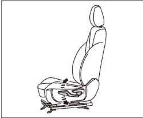
Tire de la palanca de ajuste hacia arriba para levantar la base del asiento, empuje hacia abajo la palanca de ajuste para bajar la base del asiento. (Si está equipado)
