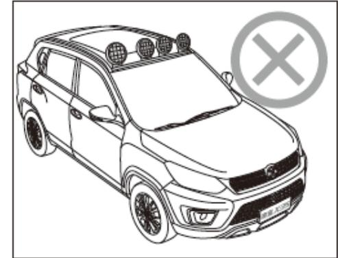
Después de instalar cualquier equipo eléctrico cuya potencia sea superior a la potencia nominal, el cableado puede sobrecalentarse debido a una carga excesiva y, puede producirse un incendio.
