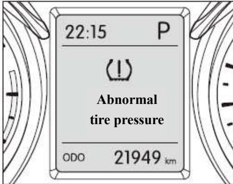
Se muestra la presión de cuatro neumáticos. Si el sistema encuentra que la presión de un neumático difiere entre cuatro neumáticos es inferior al 75% de la presión estándar, la información correspondiente aparecerá en la pantalla de información, se emitirá el sonido de advertencia y se encenderá la luz de advertencia de monitorización de la presión del neumático.
