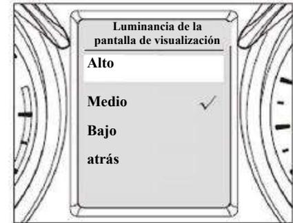
Después de ingresar a la interfaz de configuración de brillo de la pantalla, puede ver "alto", "medio", "bajo" y "regresar" de manera circular presionando brevemente el botón INFO, y seleccione un elemento presionando brevemente el botón RESET.
