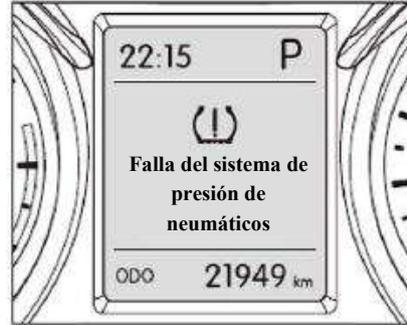
Quando se enciende el interruptor de encendido, si el sistema detecta que el vehículo está en estado anormal, la pantalla de la computadora de viaje siempre mostrará la información de la falla. En tal caso, puede almacenar la información de falla en el menú "Información de falla" y volver a la interfaz de información de falla presionando y manteniendo presionado el botón RESET.
