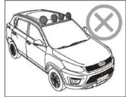
Después de instalar cualquier equipo eléctrico cuya potencia sea superior a la potencia nominal, el arnés puede sobrecalentarse debido a una carga excesivamente alta y, por lo tanto, puede producirse un incendio.
