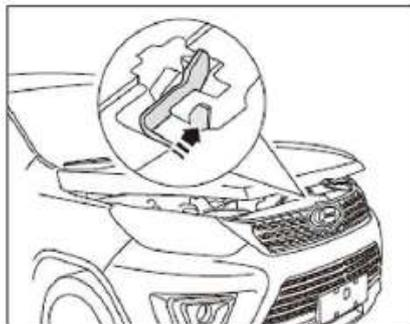
2- Levante ligeramente el cofre del motor, empuje la manija del gancho de seguridad hacia la derecha con el dedo entre el cofre del motor y la carrocería del vehículo, y luego levante completamente el cofre del motor.
