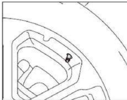
1- Desmonte la válvula ca de la válvula de la llanta y use el método de jabón para inspeccionar si la válvula tiene fugas.
