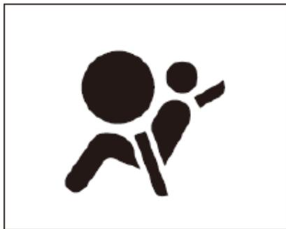
La luz de advertencia de falla del sistema de bolsa de aire en el panel de instrumentos le recordará al conductor la falla en el sistema de bolsa de aire.
