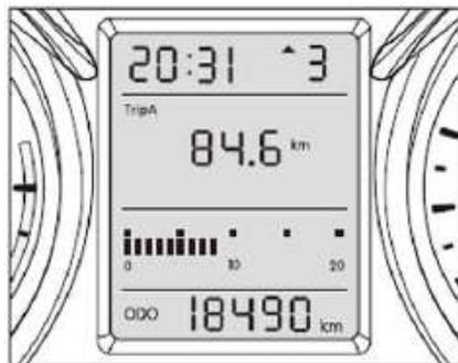
El viaje A se utiliza para calcular el kilometraje de conducción durante un período de tiempo, cuyo rango es 0.0km ~ 9999.9km. Cuando se alcanza el valor máximo, el valor del viaje A se borrará automáticamente y luego se contará nuevamente.
