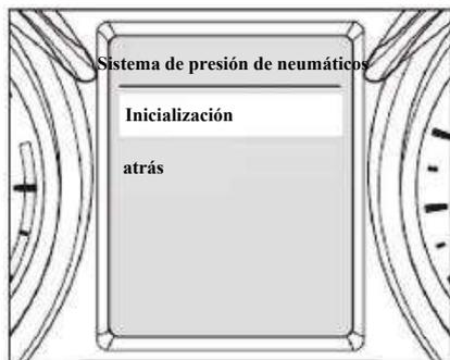
Después de ingresar a la interfaz de configuración del sistema de presión de las llantas, puede ver la información circulada presionando brevemente el botón INFO, y seleccionar un elemento presionando brevemente el botón RESET.
