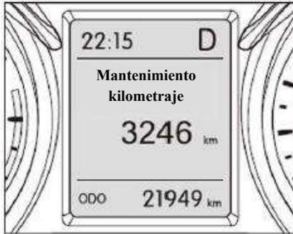
La información de mantenimiento que se muestra es el kilometraje que se cubrirá hasta la próxima vez que se deba dar mantenimiento al vehículo. El kilometraje de primer mantenimiento para el vehículo es de 5,000 km, y el kilometraje de mantenimiento de intervalo es de 5,000 km. Se aconseja al usuario que vea la información periódicamente y realice el mantenimiento a tiempo.
