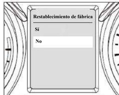
Después de ingresar a la interfaz de reanudación de valores, puede revisar la información presionando brevemente el botón INFO, y seleccionar un elemento o volver a la interfaz del menú presionando brevemente el botón RESET.
