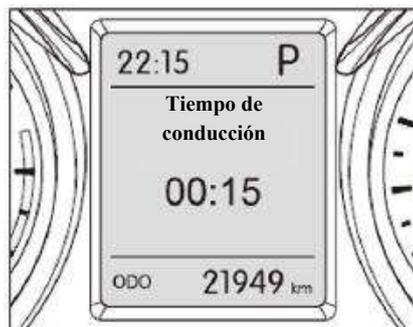
El tiempo de conducción se utiliza para mostrar el tiempo de conducción total después de que el valor se devolvió previamente a cero. El rango de valor mostrado es 0-99: 59 horas. Cuando se alcanza el valor máximo, el tiempo de conducción se borrará automáticamente y luego se contará nuevamente.
