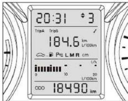
La pantalla de la computadora de viaje puede mostrar la información de viaje correspondiente. Puede revisar la información del viaje y establecer el tiempo a través del botón de operación del instrumento en el panel de instrumentos.
