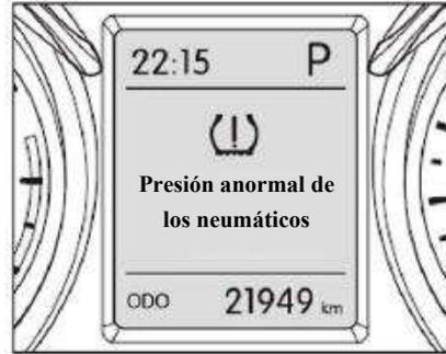
Se muestra la presión de cuatro llantas. Si el sistema encuentra que la presión de una llanta entre cuatro llantas es inferior al 75% de la presión estándar de la llanta, la información correspondiente aparecerá en la pantalla de la computadora de viaje, se emitirá el sonido de advertencia y la lámpara de advertencia de monitoreo de presión de la llanta Seguiré adelante.
