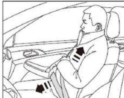
El ocupante puede tirar suavemente del cinturón de seguridad y ajustar adecuadamente la longitud del cinturón de seguridad, para ajustarlo a la posición adecuada. En primer lugar, baje la sección inferior del cinturón de seguridad hasta que cruza la cadera, y luego tire hacia arriba de la sección superior del cinturón de seguridad hasta que la sección inferior del cinturón de seguridad presione su cuerpo. De esta manera, el dispositivo pélvico, que es la parte más dura del cuerpo humano, puede
