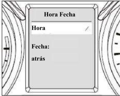
Después de ingresar a la interfaz de configuración de tipo de visualización, puede ver la "hora", la "fecha" y el "retorno" de forma circular presionando brevemente el botón INFO, y seleccione la hora de visualización o la fecha de visualización presionando brevemente el botón RESET.
