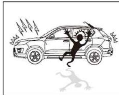
Después de bloquear el vehículo con la llave del control remoto, el vehículo entrará en el estado antirrobo y luego todas las puertas, el cofre del motor y la cajuela estarán en estado monitoreado. Si la puerta, la cajuela o el cofre del compartimento del motor se abren ilegalmente, por ejemplo, alguien obliga a abrir la puerta, se activará la alarma.
