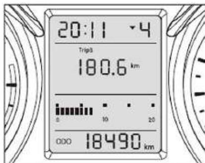
Al igual que el viaje A, el viaje B se usa para calcular el kilometraje de conducción durante un período de tiempo, cuyo rango es 0.0km ~ 9999.9km. Cuando se alcanza el valor máximo, el valor del viaje B se borrará automáticamente y luego se volverá a contar.
