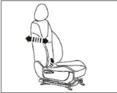
Ajuste del ángulo de inclinación para el respaldo del asiento:
