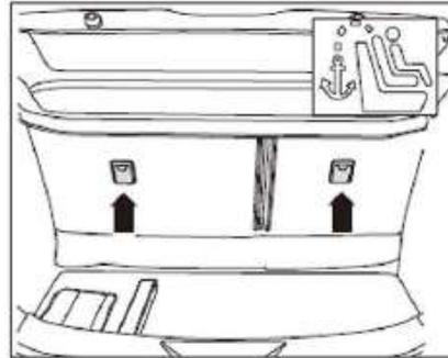
El soporte de anclaje de fijación superior se encuentra en el medio del respaldo del asiento trasero (cuya posición se indica con el signo "ISOFIX"). El soporte de anclaje de fijación superior para el asiento de seguridad para niños es invisible en el compartimento de pasajeros, y se puede ver después de que el respaldo del asiento trasero esté plegado o desde el interior de la cajuela.
