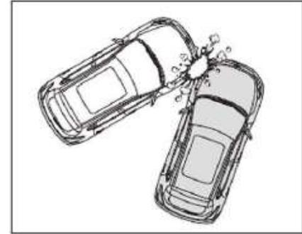
En caso de colisión fuera del ángulo, la energía de impacto recibida por el sistema de bolsa de aire puede no ser lo suficientemente alta como para activar la bolsa de aire frontal. En tal caso, es posible que la bolsa de aire frontal no se despliegue y que la bolsa de aire lateral \* y la bolsa de aire de cortina lateral \* no funcionen.
