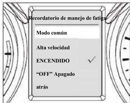
Después de ingresar a la interfaz de configuración de recordatorio de manejo de fatiga, puede ver el "modo ordinario", el "modo de alta velocidad", "encendido", "apagado" y "regresar" de manera circular presionando brevemente el botón INFO, y seleccione un elemento presionando brevemente el botón RESET.
