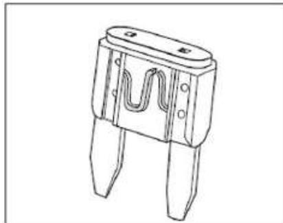
Extraiga el fusible correspondiente al equipo eléctrico que falla y realice la inspección.
