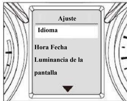
Cuando el interruptor de encendido está en la posición "ON", puede ingresar a la interfaz de configuración del instrumento presionando y manteniendo presionados los botones INFO.
