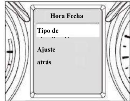
Después de ingresar a la interfaz de configuración de hora / fecha, puede ver el "tipo de visualización", "establecer" y "regresar" de manera circular presionando brevemente el botón INFO, y seleccione un elemento presionando brevemente el botón RESET.
