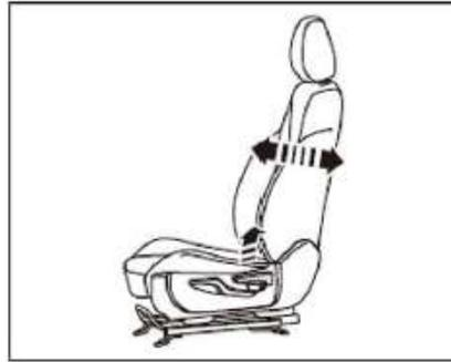
Ajuste del ángulo de inclinación para el respaldo del asiento:
